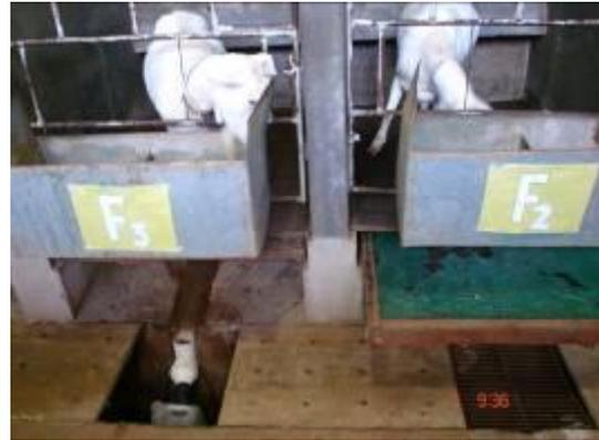
**Figura 2** - Sistema coletor de dejetos adaptado nas gaiolas metabólicas
