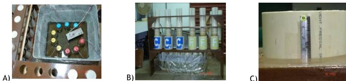
**Figura 4** - Vista geral dos biodigestores e gasômetros: A) vista superior dos biodigestores inseridos dentro da caixa d'água de fibrocimento; B) vista frontal dos gasômetros; C) detalhe da régua graduada fixada no gasômetro para a leitura do deslocamento
